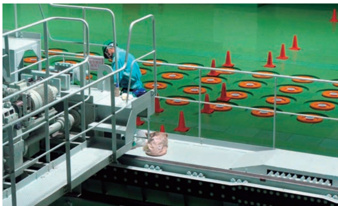
青森県六ヶ所村の日本原燃・使用済み核燃料再処理工場。オレンジ色のふたの下に高レベル放射性廃棄物を一時貯蔵（共同）＝2012年10月3日
